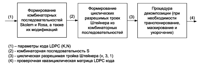
Рис. 4. Обобщённый алгоритм синтеза проверочных матриц LDPC кодов на базе циклических разрешимых троек Штейнера
